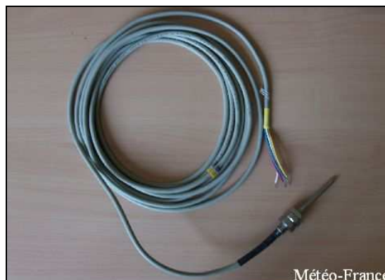
Photo 2 : Sonde thermométrique Pt100 © Météo-France
