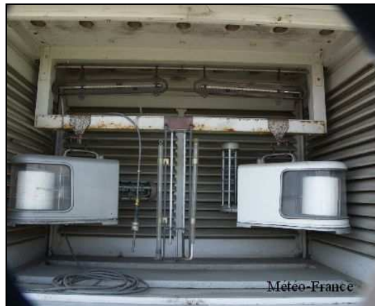
Photo 1 : Thermomètres à minimum et maximum (en haut) et thermographe dans l'abri Stevenson © Météo-France
